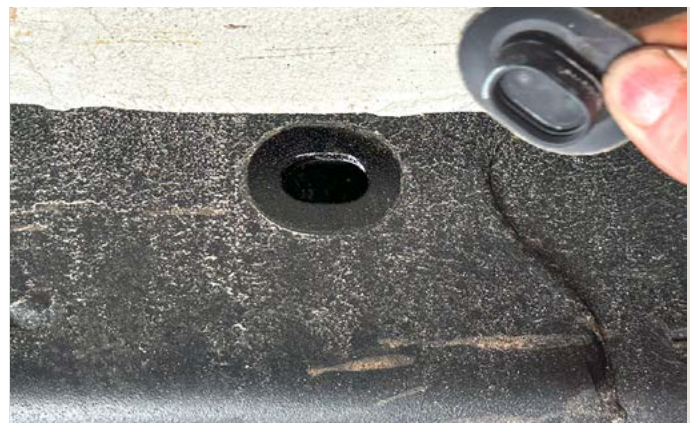
12. Remove grommet using a small pry bar.
