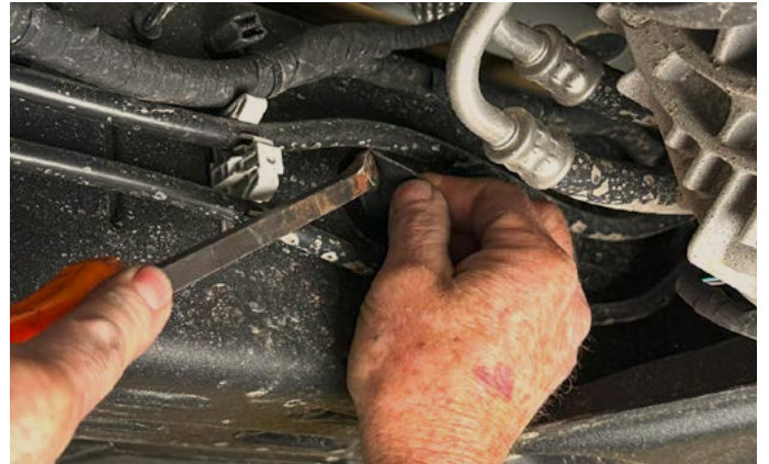
14. Remove grommet using a small pry bar.
