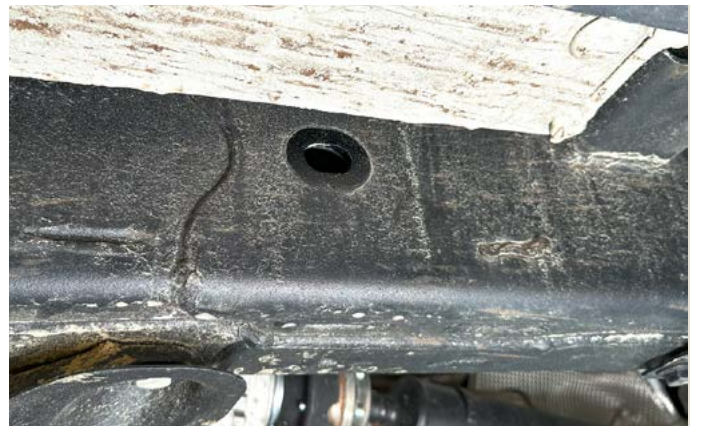
16. Remove grommet using a small pry bar.
