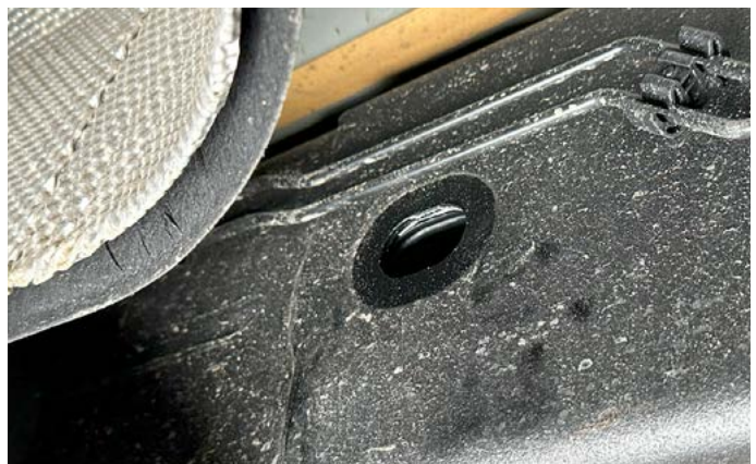
10. Remove grommet using a small pry bar.
